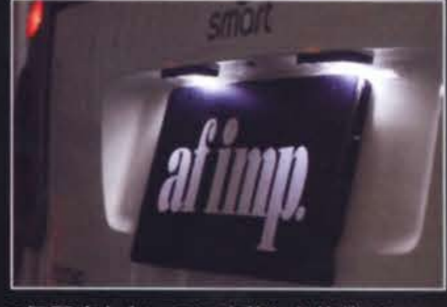
2灯両方ともLEDに交換した状態がコレ。impプレートではなく、普通のナンバーなら、蒼白光でナンバープレートがより輝いて見えるハズだ
