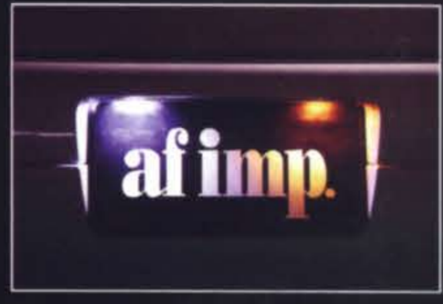
左がLED、右側が従来のバルブ。色の違いも明るさも一目瞭然。消費電力も抑えられるから、AVメイクで増えたバッテリーの負担もよって軽減?
