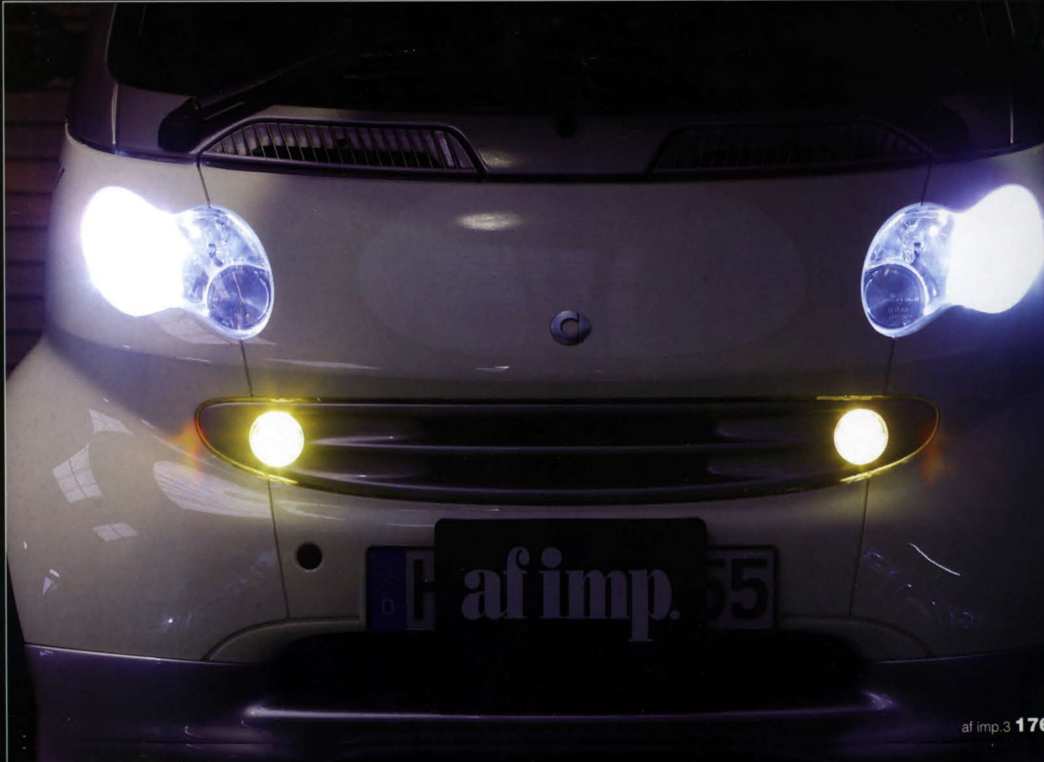
ロービームに6000K、フォグにイエロー光のHIDを組み込んだクルーズのデモカー、スマート。このクルマの詳細は次号で紹介するぞ
