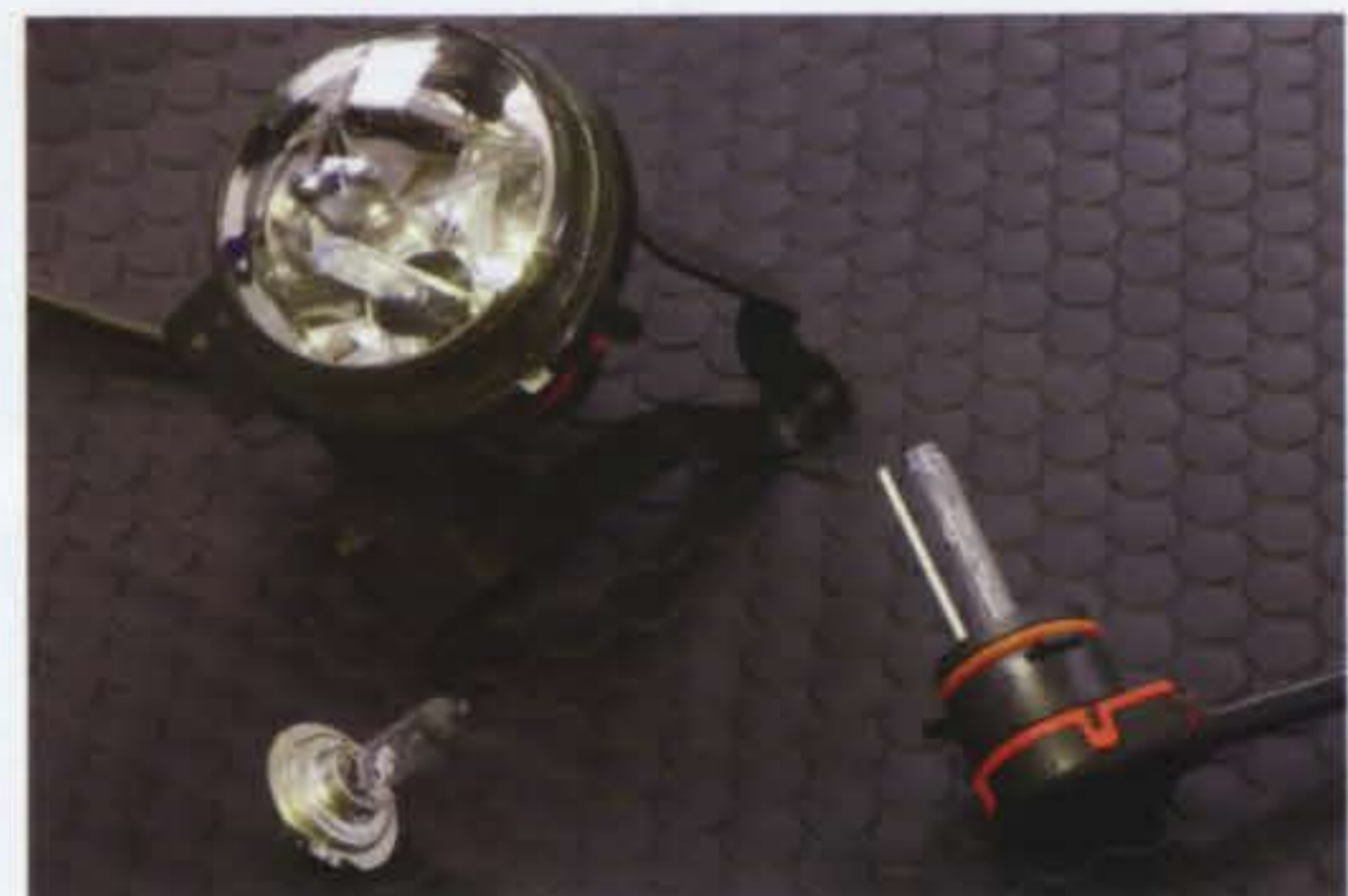
左がハロゲン、右がHID。レンズ部分の明るさはハロゲンでもまずまずだけど、全体での明るさはHIDの方が断然上。それに白さが高級感を高めるのだ
