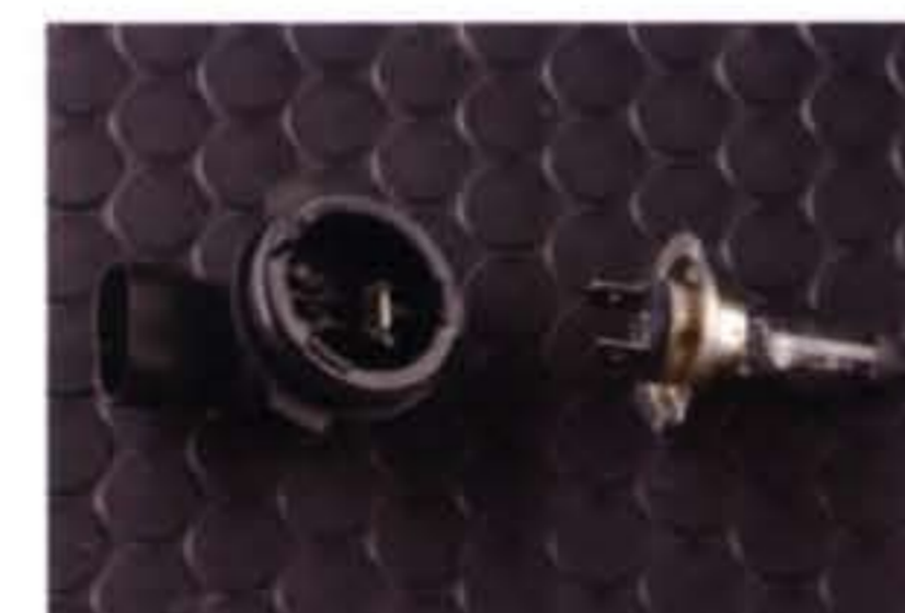
フォグランプはバルブが差し込まれたソケットでランプユニットと固定する方式。このソケットと同形状のアダプターがあれば装着は不可能なのだ
