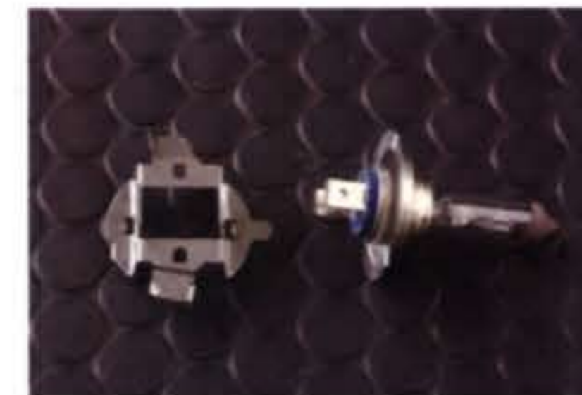
ロービームの方は、ハロゲンバルブを金具で固定する方式。このバルブ形状に合わせてバーナーを用意すれば、HID化は可能だ
