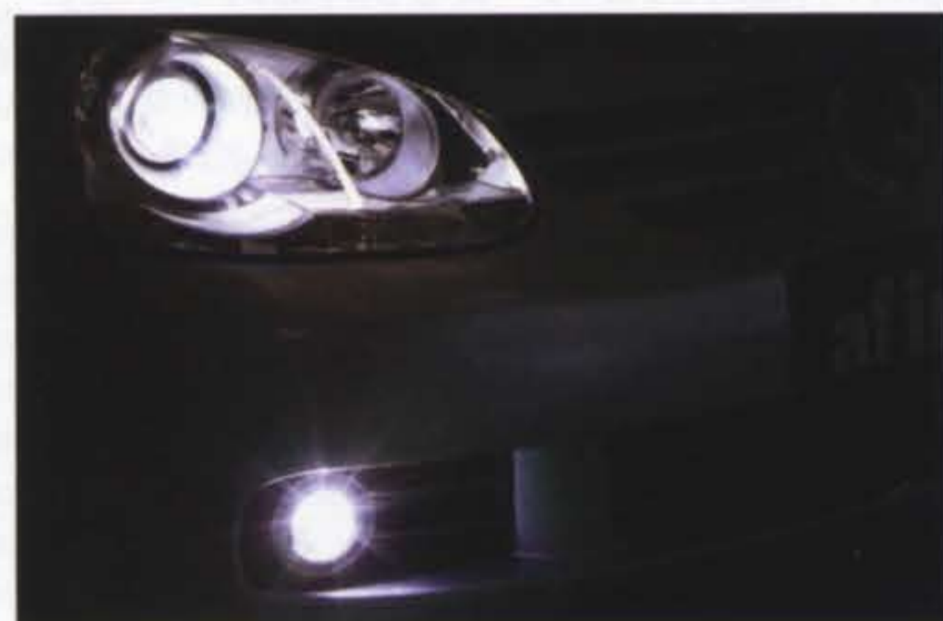
交換前のハロゲンビーム。プロジェクターランプ特有のレンズが個性的な表情を感じさせてくれるけれど、光量不足は否めない感じだ
