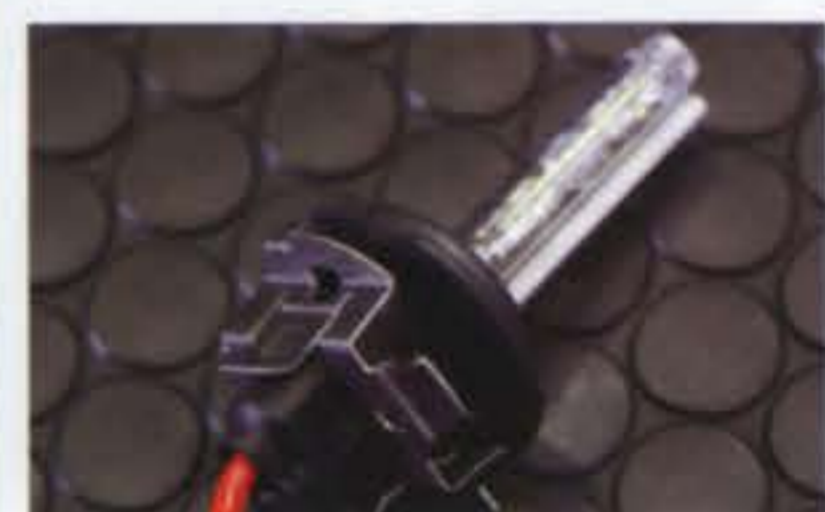
HIDバーナーの取り付け自体はカンタン。純正のハロゲンバルブと交換するようなものだ
