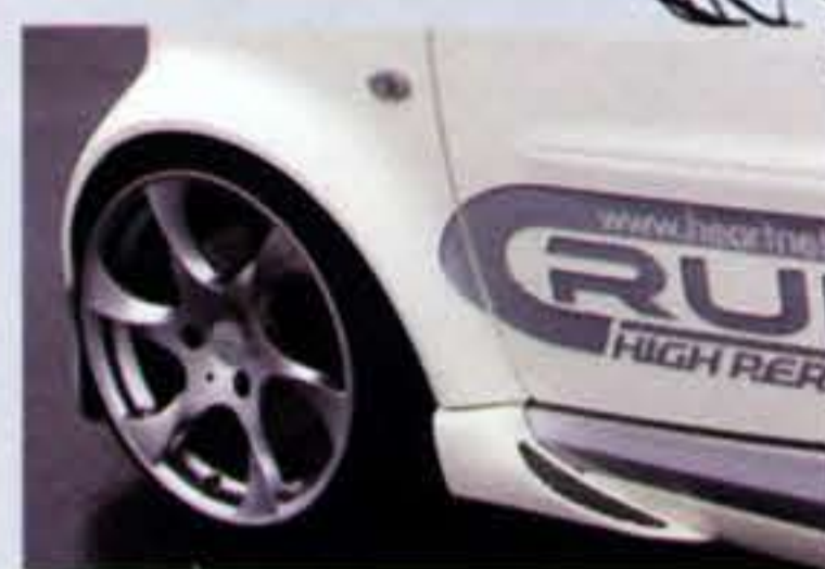
↑サイドスカートはブラバス製を前側だけ装着。しかもダクト部分を加工してメッシュを組み込んでいるのだ
