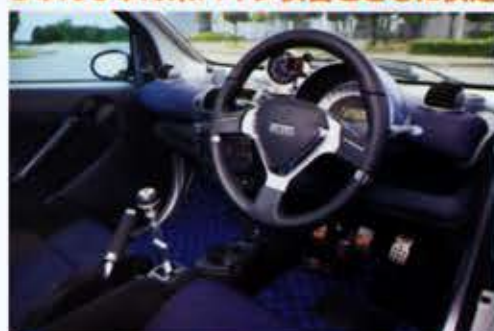
↑ダッシュはMOMOのステアリングにペダルカバー、クラッチペダルの追加に注目。シフトレバーもアルミ製でサイドブレーキも改造済みだ ←シートは左右レカロなど、運転席はフルバケに変更。フロア形状のせいで、これ以上ポジションを下げられないのがツライところだ
