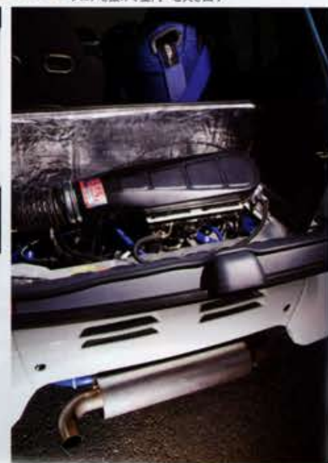
←ホイールはランサーからBBSのLMに変更。3穴はナイからPCDチェンジャーを利用する ↓パワーユニットは175psを発生するスズキGSX-R用。フロアを抜けて室内へと突き出す
