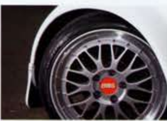
←ホイールはランサーからBBSのLMに変更。3穴はナイからPCDチェンジャーを利用する ↓パワーユニットは175psを発生するスズキGSX-R用。フロアを抜けて室内へと突き出す
