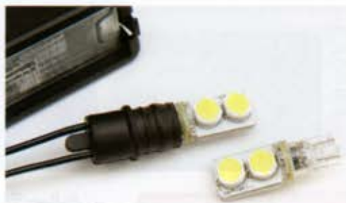
VWゴルフV用ライセンス用LED (年内発売予定) ↑こちらは開発中のVWゴルフV用のナンバー灯。バルブだけでなく、防水も考えたゴムのコネクター部分までセットする予定なので要チェック
