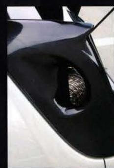
GSX-Rのエンジン高に合わせて、エアインテークをBピラー後ろのクォーターガラス部分に設置。ダクトはスーブラを加工したもの。
