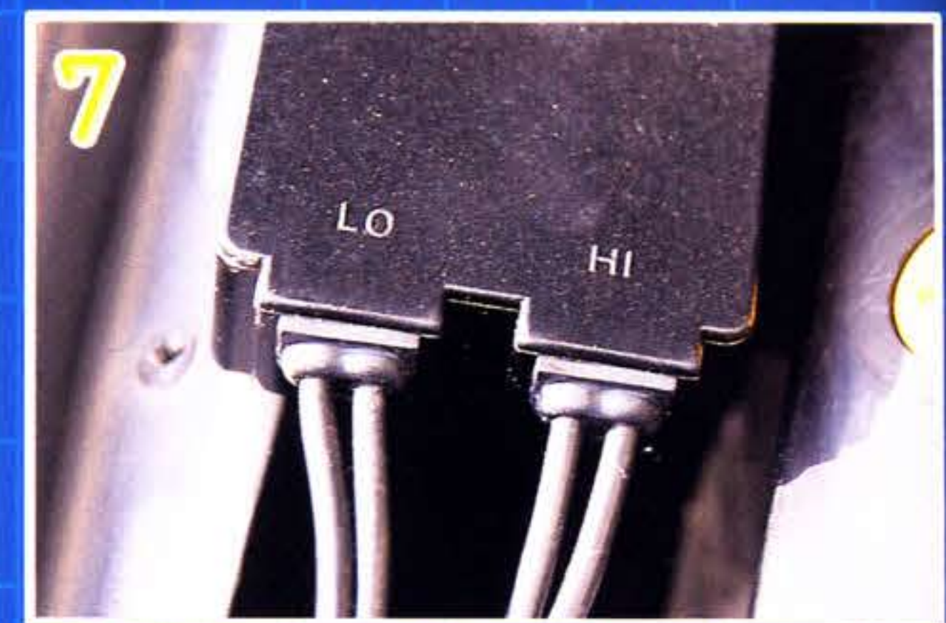
HI/LOスターターユニットで分岐されたコードを、ツインバルブのHIとLoにそれぞれ接続する。
