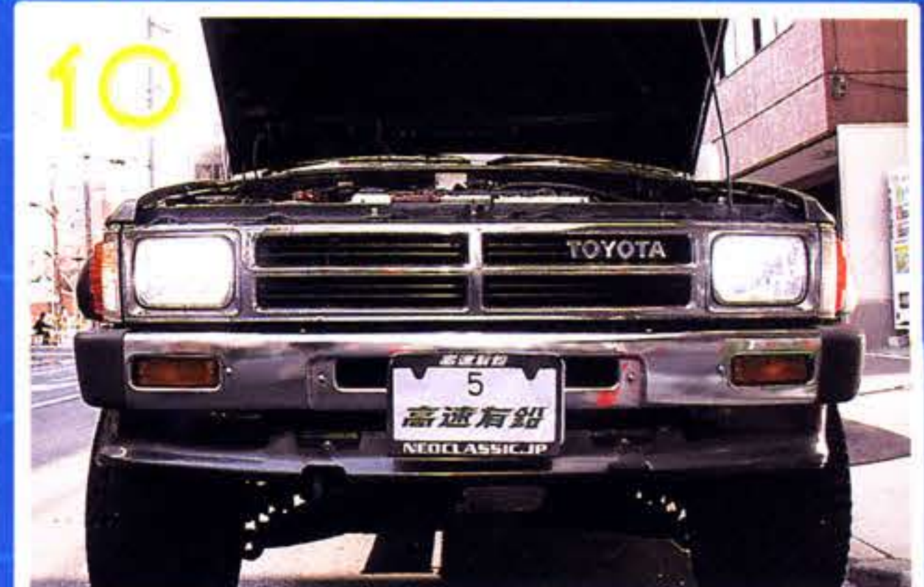
2灯ライトのクルマでも、簡単にHID化が可能だ。Hi/Lo切り替え用モーターやソレノイドがないのでトラブルが少なく安心だ。
