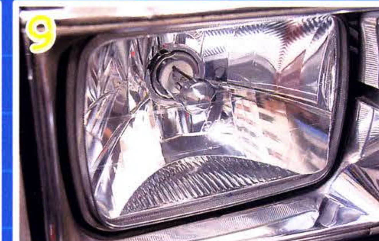
H4型バルブ交換型なので、シールドビーム車に装着の場合は、あらかじめH4ヘッドライトを用意する必要がある。
