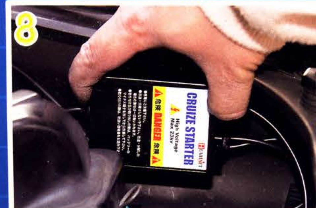
スターターは、ヘッドライトまで配線が届く位置に装着、固定する。これで片側が終了した。反対側も同じ作業を行う。
