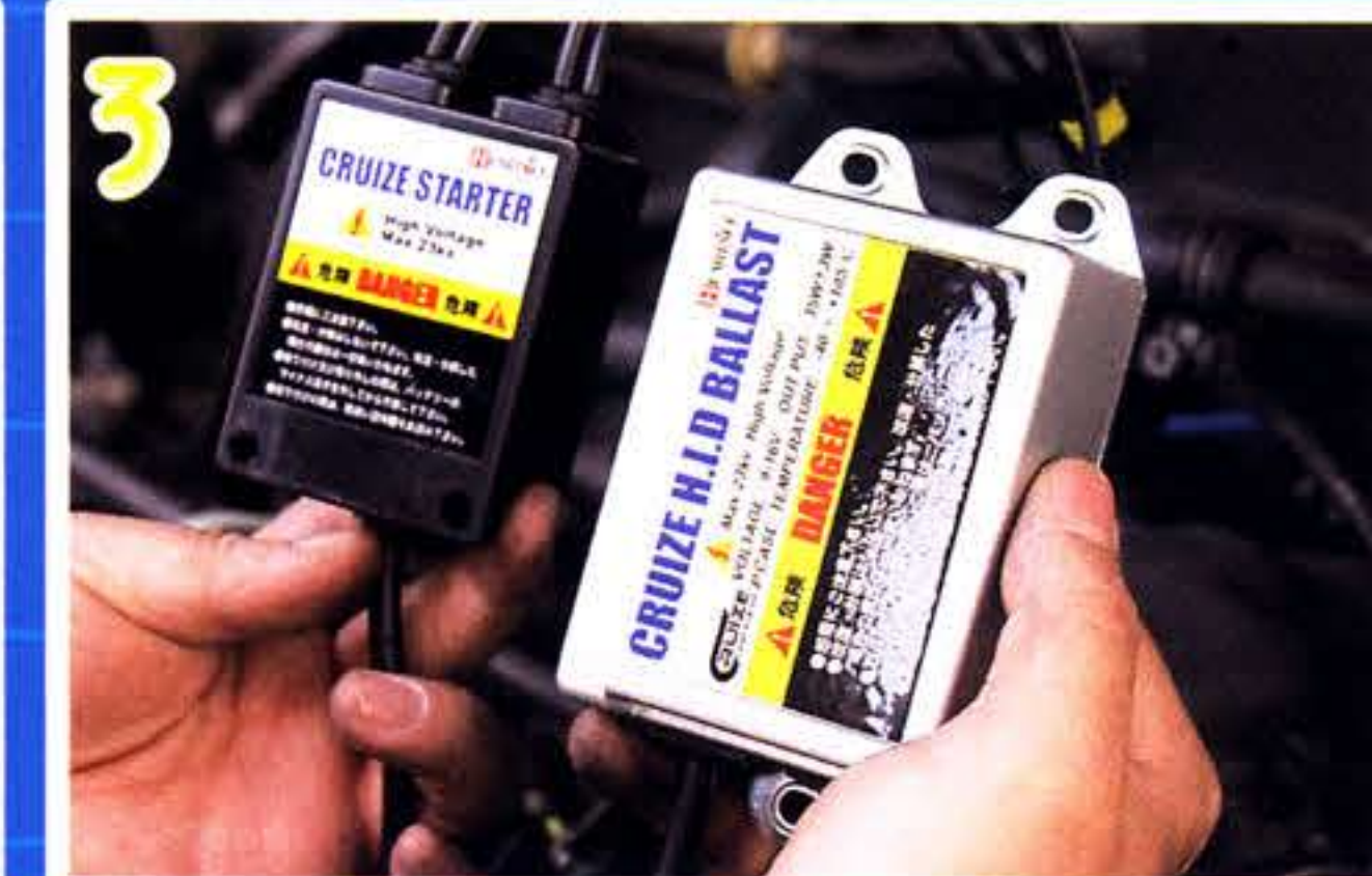
写真右が、高電圧を供給するバラストユニット。左側が点灯時の大電流を制御するスターターと呼ばれる装置。
