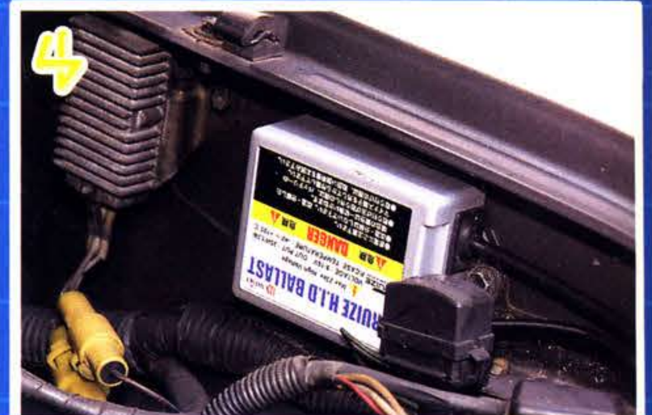
バラストユニットは高温発生源から離し、インナーフェンダーなど、しっかりと固定できる場所を選んで装着する。
