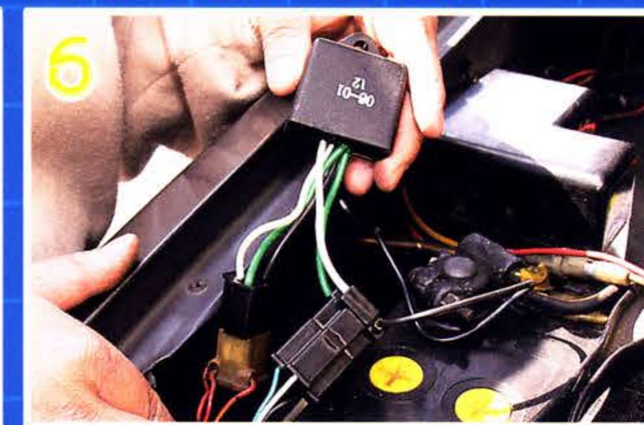
取材車両のYN61Gサーフの場合にはマルチリレーキットが必要となる。しかし完全カブラーオン設計なので配線は簡単。
