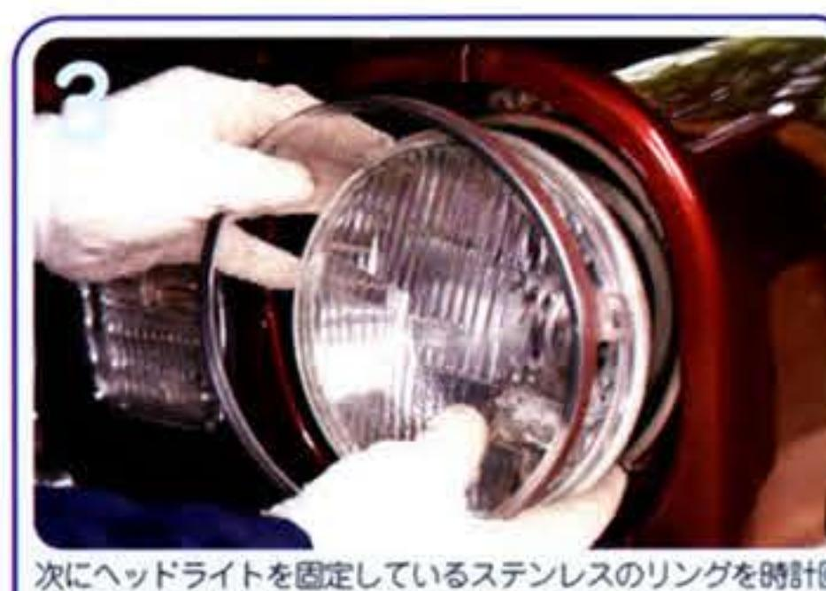
次にヘッドライトを固定しているステンレスのリングを時計回りに少し動かしてみよう。これでリングは簡単に外れるはず。一緒にライトも外れるので注意!
