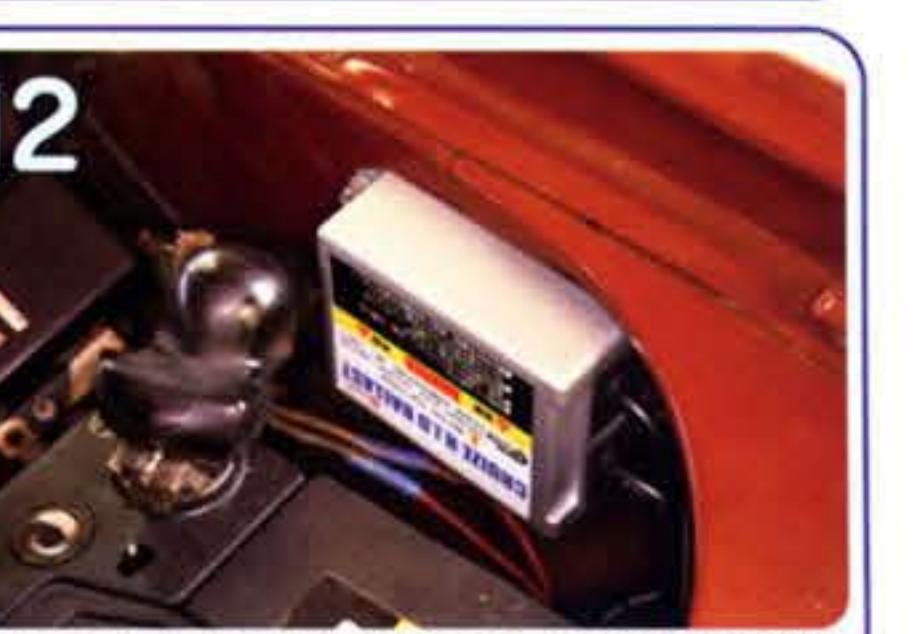
バラストユニットは、水や埃を避けつつ、できるだけエンジンの熱の影響を受けにくい位置への装着がベスト。今回はボディ裏側のインナーフェンダーに固定。
