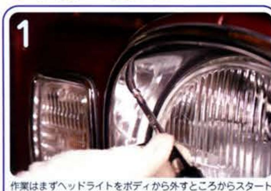
作業はまずヘッドライトをボディから外すところからスタート。ブタ目のベゼルは写真の10時の位置と2時の位置をネジで固定されているのでこれを外す。
