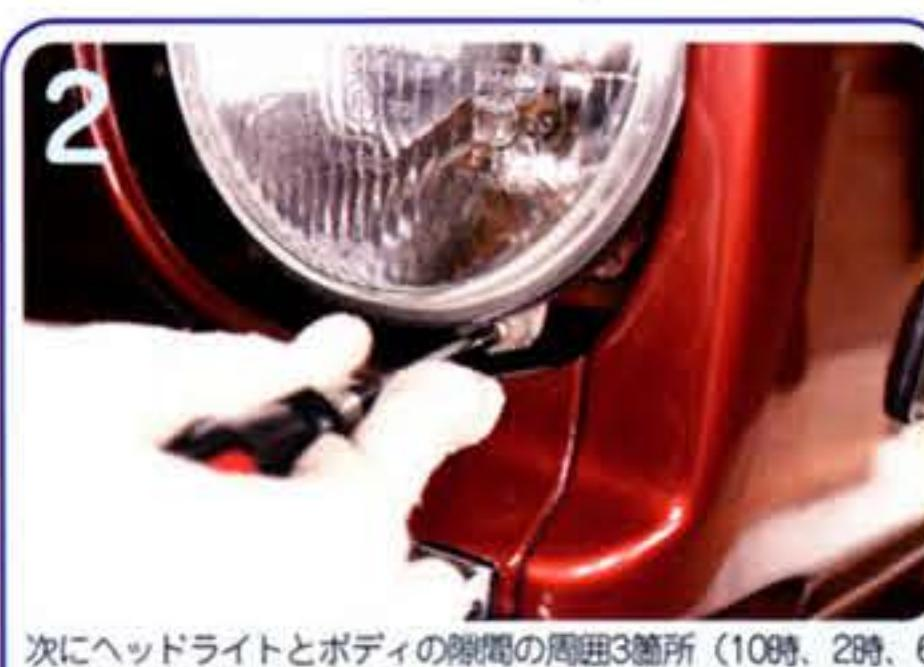
次にヘッドライトとボディの側面の周囲3箇所(10時、2時、6時の箇所)の固定ネジを緩める。ネジは全部外さずに緩めるだけOK。
