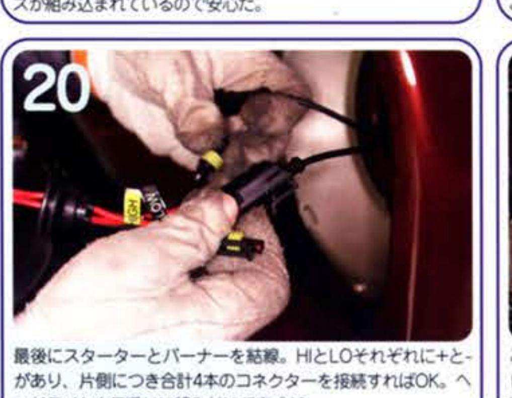
最後にスターターとバーナーを接続。HiとLoそれぞれに+と->片側につき合計4本のコネクターを接続すればOK。ヘッドライトを元通りに組み付けて完成だ。
