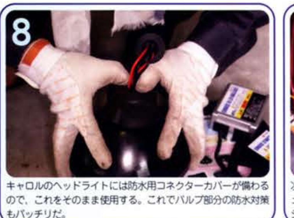
キャロルのヘッドライトには防水用コネクターカバーが備わるので、これをそのまま使用する。これでバルブ部分の防水対策もバッチリだ。
