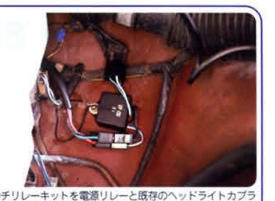
マルチリレーKITを電源リレーと既存のヘッドライトカブラーに割り込ませて接続。これで電源はバッテリーから直接取ることになるため、旧車でも安心だ。
