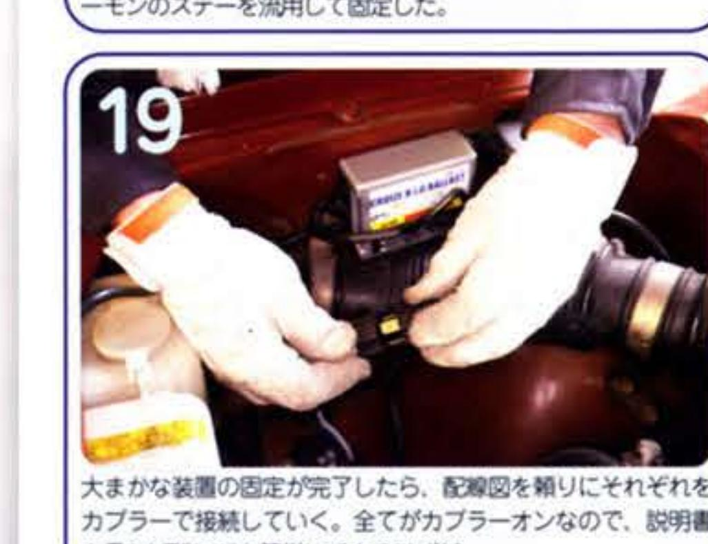
大まかな装置の固定が完了したら、配線図を頼りにそれぞれをカブラーで接続していく。全てがカブラーなので、説明書を見れば誰にでも簡単にできるはずだ。
