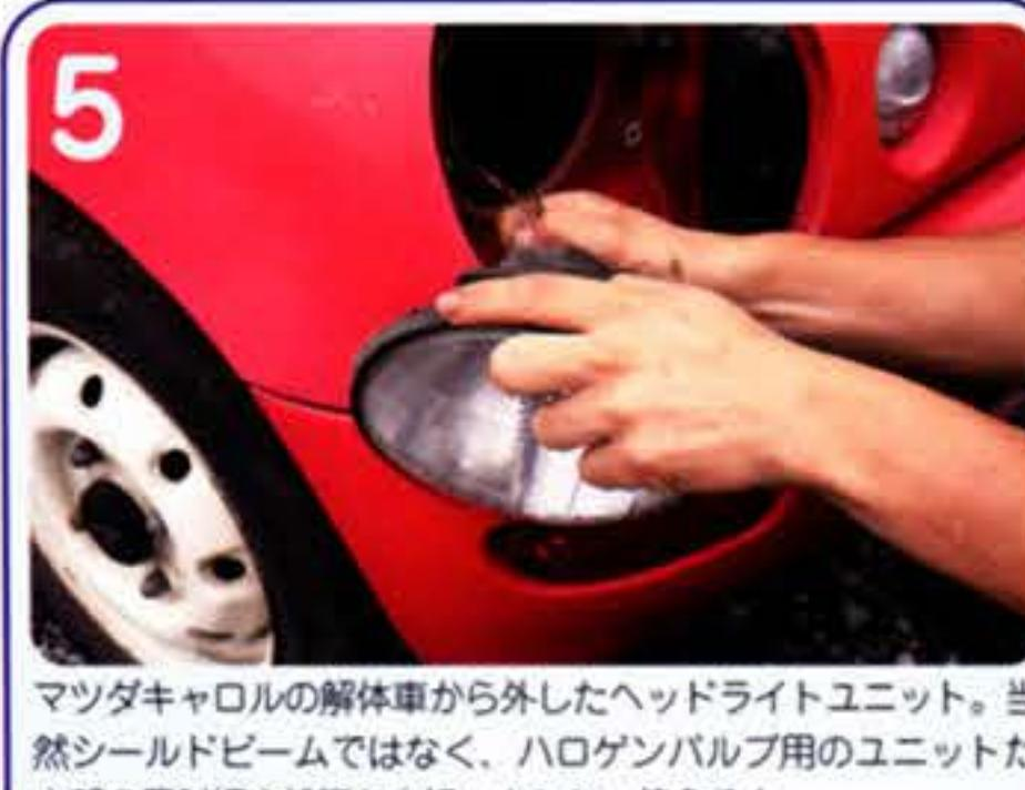
マツダキャロルの解体車から外したヘッドライトユニット。当然シールドビームではなく、ハロゲンバルブ用のユニットだ。内部の反射板の状態も良好。ウシシ、使える!
