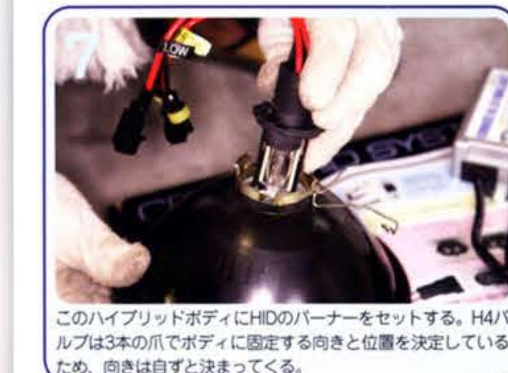
このハイブリッドボディにHIDのバーナーをセットする。H4バルブは3本の爪でボディに固定する向きと位置を決定しているため、向きは自ずと決まる。
