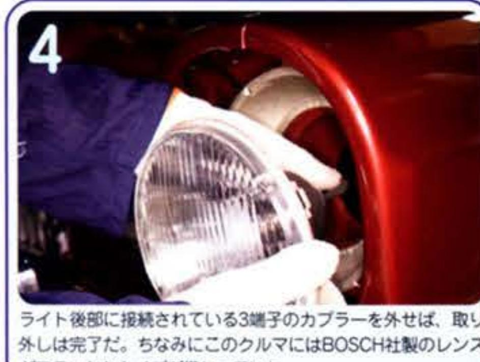
ライト後部に接続されている3端子のカブラーを外せば、取り外しは完了だ。ちなみにこのクルマはBOSCH社製のレンズがフラットなタイプが備わっていた。
