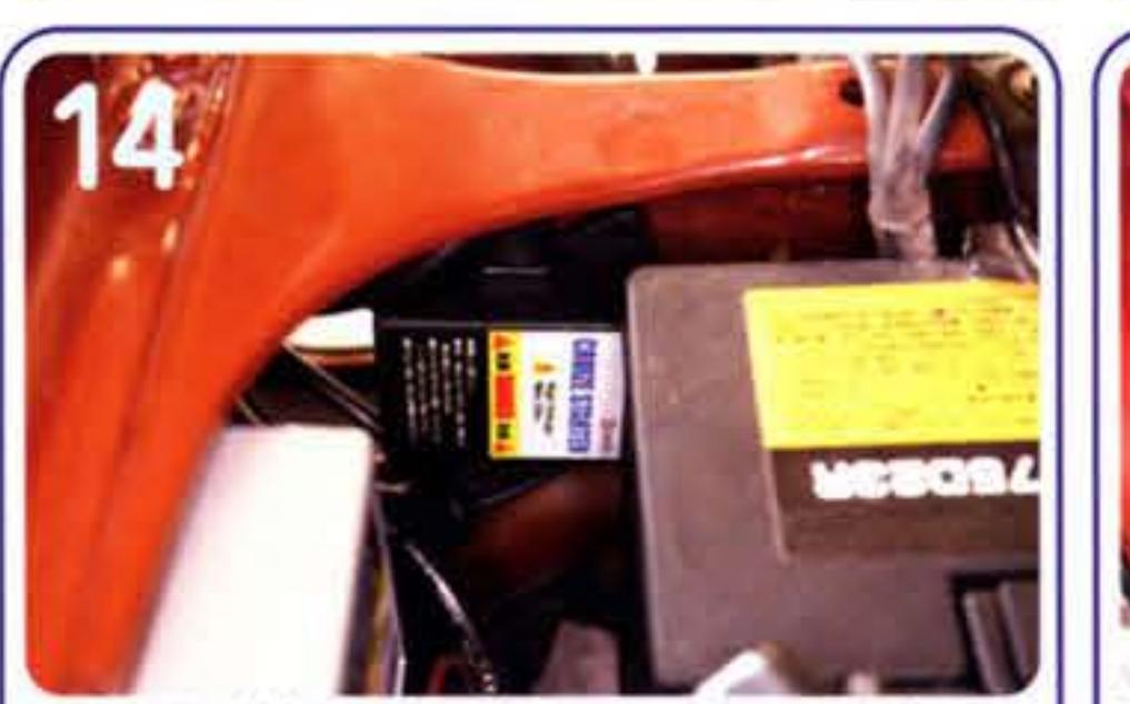
H1-HOの切り替えを担当するスタータユニットは配線の長さの関係で最もヘッドライトに近い位置に固定する必要がある。左側はヘッドライトの真裏に固定された。
