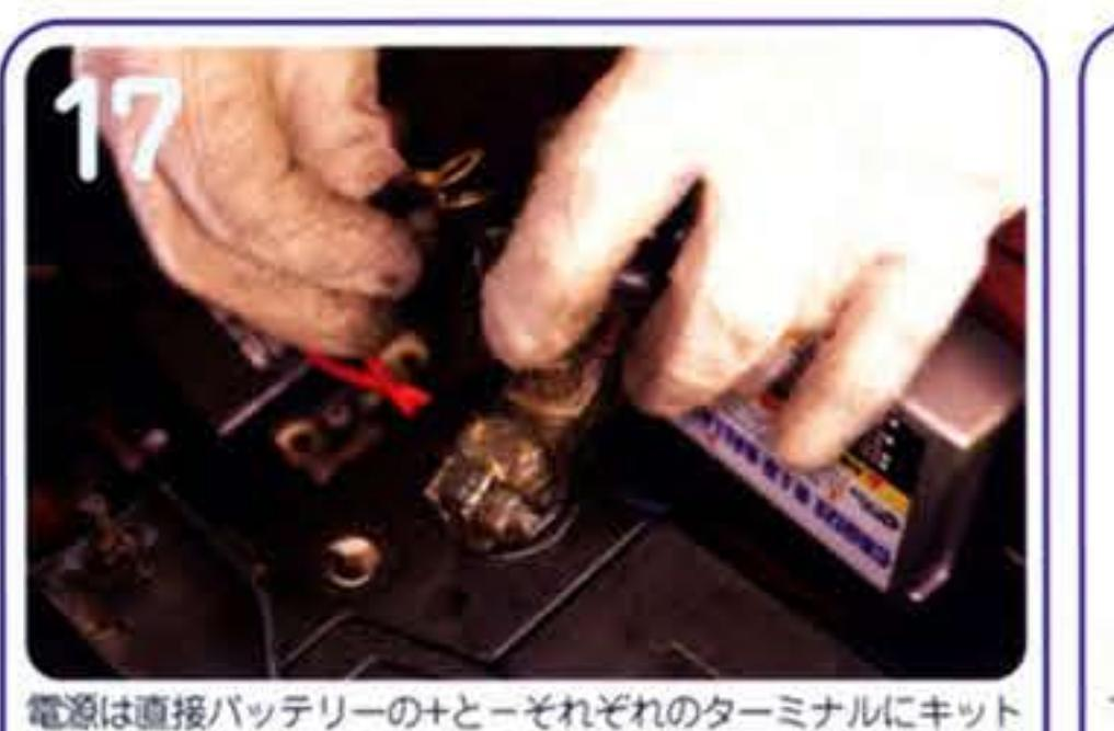
電源直結バッテリーのと一ぞれのターミナルにキットの配線を接続して取り出す。ちなみにキットの配線にはヒューズが組み込まれているので安心だ。
