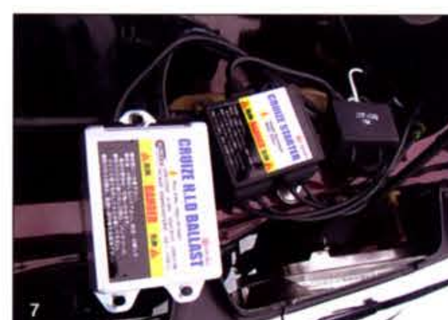
配線はオスとメスを接続するだけの簡単な作業で終わり。だがHIDのバラストと呼ばれるユニットとリレーを固定する必要がある。
