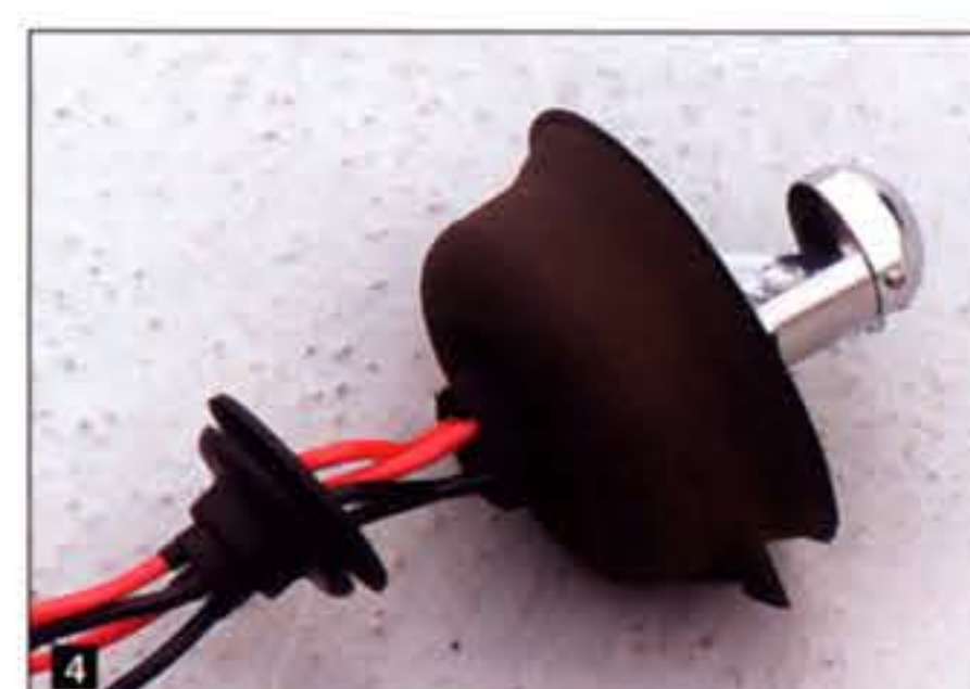
ノーマルのバルブに使われているゴム製のダストブーツを、少し加工してHIDバルブに流用することに。穴を広げて貫通させたところ。
