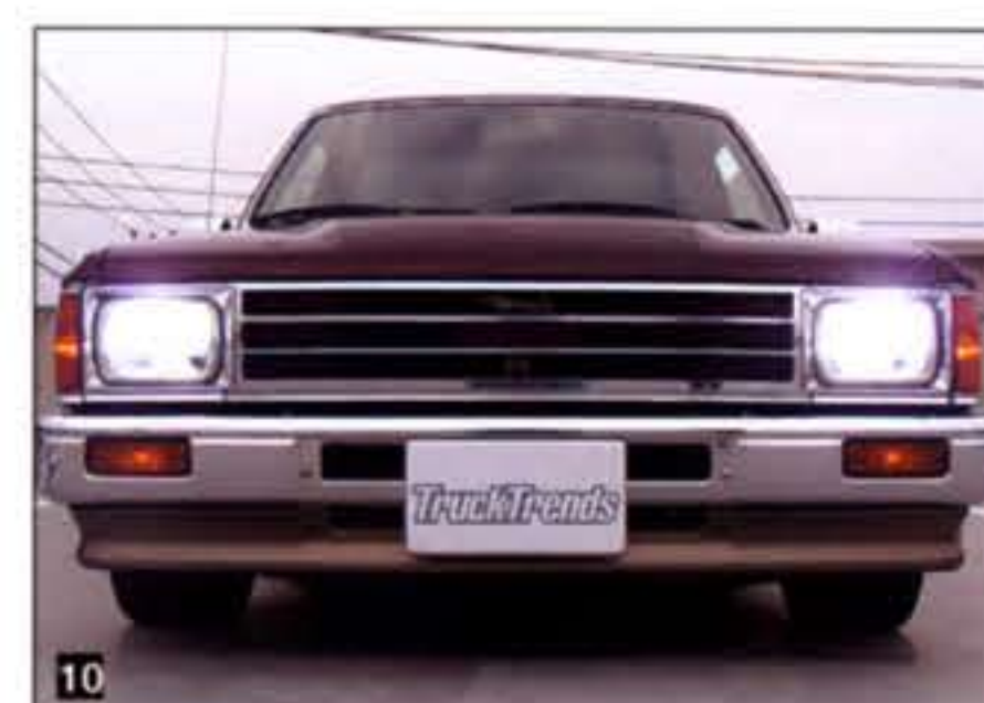
ユニットや配線をきれいにまとめたら、いざ点灯!電流が流れるとまずブルーに発光し、すぐに白い閃光を放ち始める。明るい!
