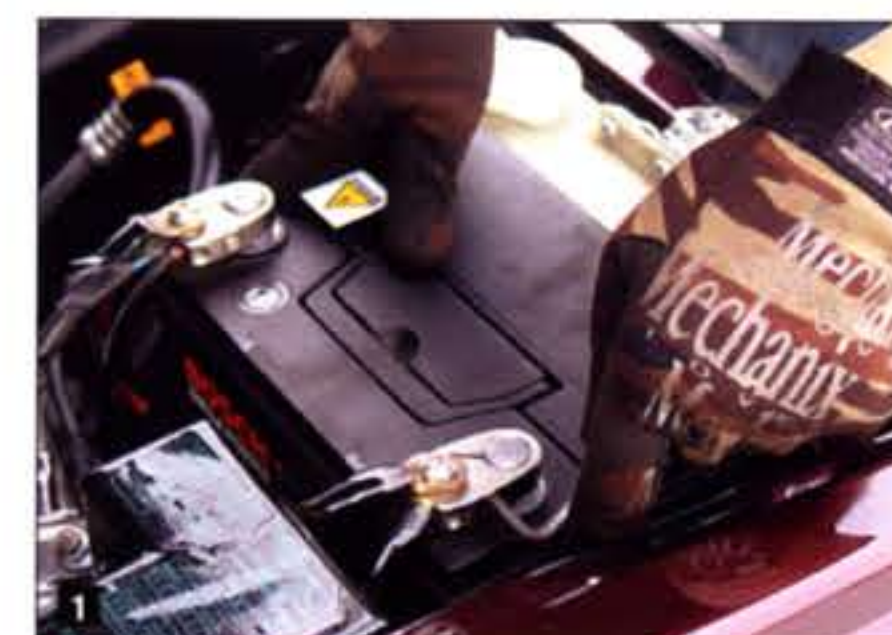
電気関係の作業をするときの基本中の基本として、まずバッテリーのマイナス端子を外す。今回は作業の邪魔なので丸ごと降ろした。
