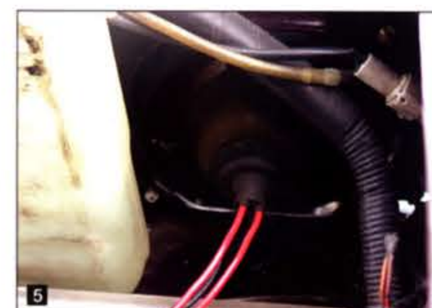
ブーツを付けて、再び装着テスト。問題なさそうなので、次のステップである配線作業に進むことにする。
