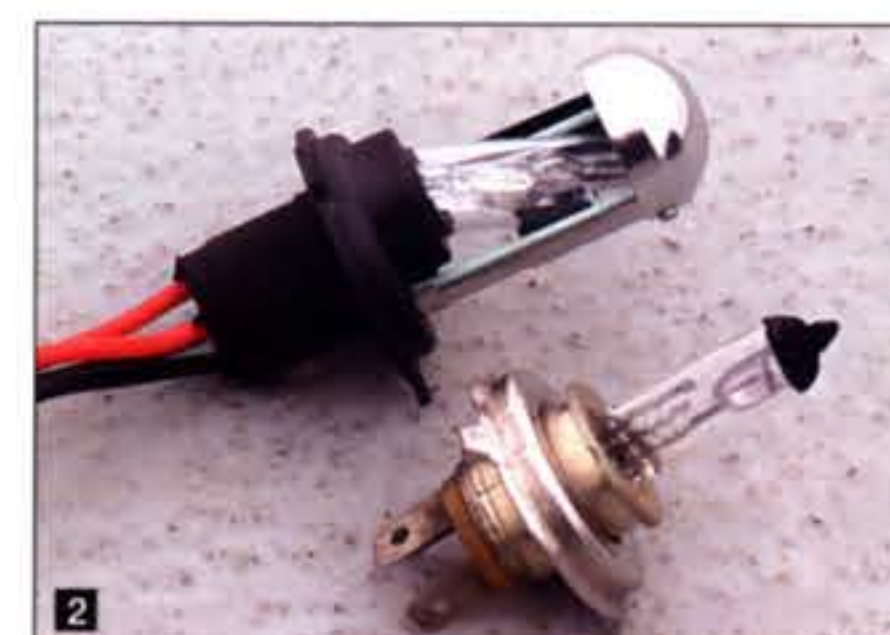
まずノーマルのH4ハロゲン球を取り外す。デュアルバルブ式HIDはバックスペースが25mmと、ほとんど邪魔にならないサイズだ。
